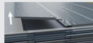
A Hardie® VL Plank homlokzati lemezek egymásba illesztve kerülnek kiszállításra. A paneleket a raklapról való kivételkor oldalirányban kell kihúzni, és csak ezután szabad felemelni.
