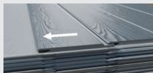
A Hardie® VL Plank homlokzati lemezek egymásba illesztve kerülnek kiszállításra. A paneleket a raklapról való kivételkor oldalirányban kell kihúzni, és csak ezután szabad felemelni.
