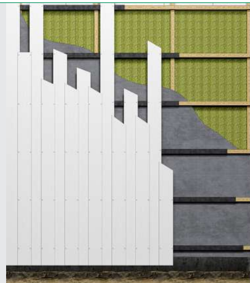
A kettős fedésű burkolat általános képe.
