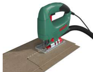
Sarokkivágás esetén a belső sarokban legalább 8 mm-es lyukat kell fúrni a lap törésének megelőzése érdekében.
