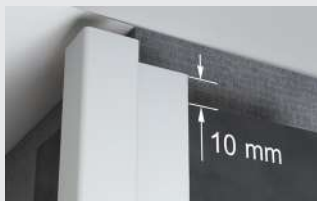
A Hardie™ Plank MetalTrim™ sarokprofilnak alul és felül 10 mm-rel kell túlnyúlnia.
