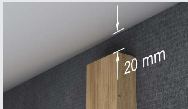
Minimális távolság a lécs felső éle és a burkolat felső síkja között.
