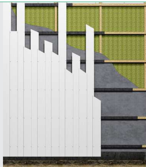
A kettős fedésű burkolat általános képe.
