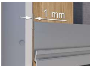
A szellőzőprofil rögzítése.
