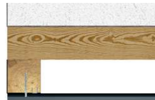
A homlokzatburkolat síkba illesztése az ablak kávéjánál
