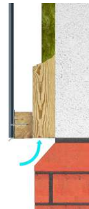
A külső sarokprofil alsó élét a lábazati profil alsó élével egy síkban kell felszerelni
