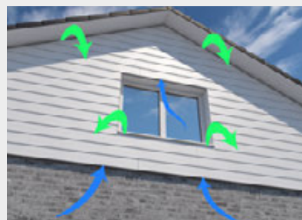
grün: Abluft blau: Zuluft
