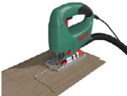
Bei einem Eckausschnitt ist in der inneren Ecke ein min. 8 mm Loch zu bohren, um ein Brechen der Platte zu verhindern.
