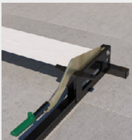
Beim Zuschneiden mit dem Hardie™ Guillotine Schneidewerkzeug muss die beschichtete Seite nach oben zeigen.
